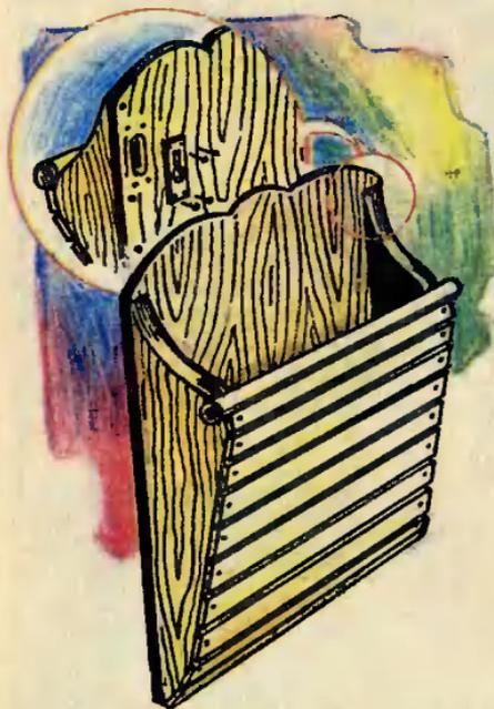
заднюю стенку прикрепите к боковым шурупами. Рейки прибейте гвоздями. Верхнюю, круглого сечения, прикрепите, вбив в деревянные стойки по одному гвоздю — до середины. Шляпки откусите, смажьте клеем «ПВА», а теперь набейте на них рейку. На задней стенке высверлите два углубления и с помощью шурупов обрамите их металлическими пластинками.
